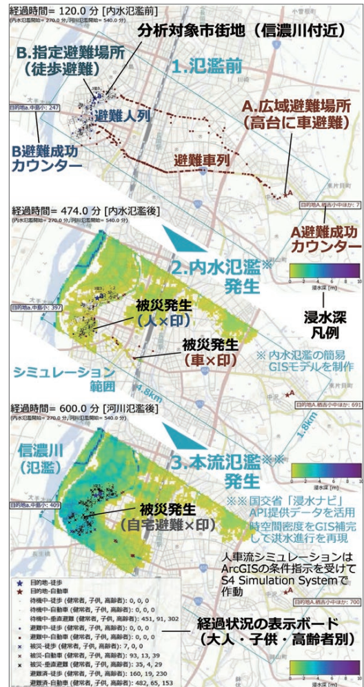
図3 長岡市との協定研究で共同開発した洪水避難の広域人車流シミュレーション（津波や震災時避難行動にも適用可能）
